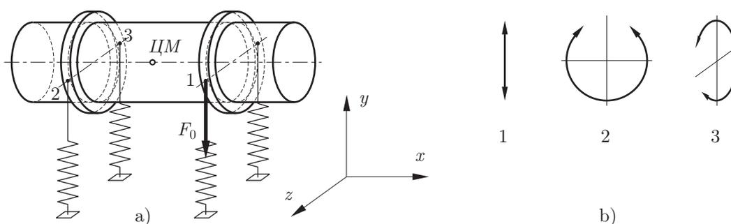
Рис. 1 Схема экспериментального стенда (а) и формы колебаний (б)
